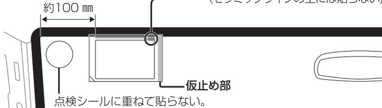
3 セパレーターをはがし、フィルムをガラスに貼り付ける
