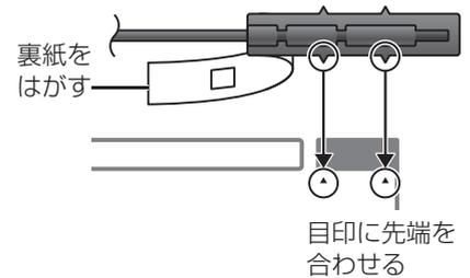
2 アース端子を金属部(塗装面)に貼り付けて、コードを引き回す
