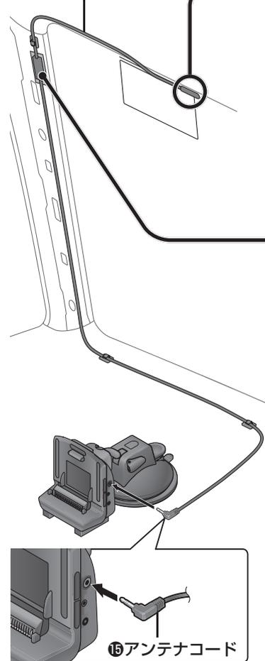
1 コードの端子を、アンテナの給電部に貼る
