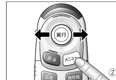
メニューを押す、またはジョイスティックを左右に動かして横方向に項目を移動し、“画面調整”または“入出力設定”を選ぶ。ディスプレイユニットの操作では、MENUを押します。
