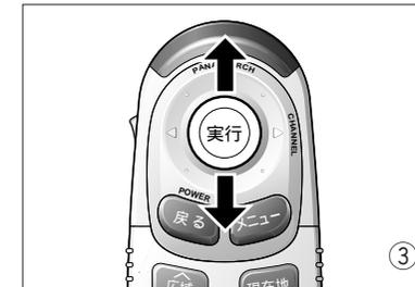
さらに、ジョイスティックを上下に動かして縦方向に項目を移動する。
