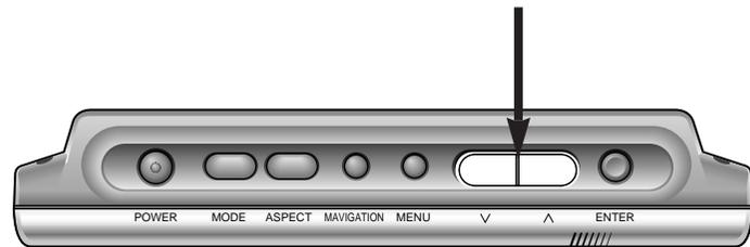
リモコンの場合にはジョイスティックを左右に動かす, ディスプレイユニットの場合にはボタンで操作します。
