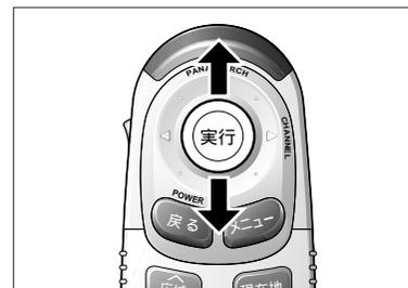
ジョイスティックを上下に動かすと, メモリー一覧表の中でカーソルが移動し, 選択されているチャンネルに切り替わる。
