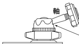
軸の下面をリングの溝に密着させてください。
