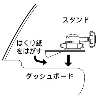
貼り付け面を貼り付け場所の形状に合わせて、曲げてください。
