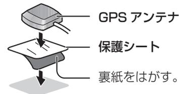
※ ルーフキャリアの近く、またはトランクリッドなどに取り付けると、GPS 衛星からの電波を受信しにくくなります。
