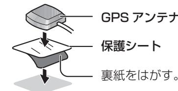
※ ルーフキャリヤの近く、またはトランクリッドなどに取り付けると、GPS衛星からの電波を受信しにくくなります。
