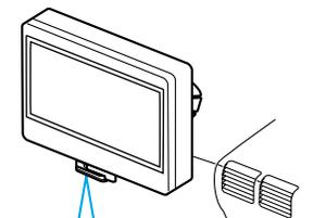
ダッシュボードに取付ステーが近接するときは振動でノイズが発生する原因になります。クッション材を貼り付けてナビゲーション本体を安定させてください。
