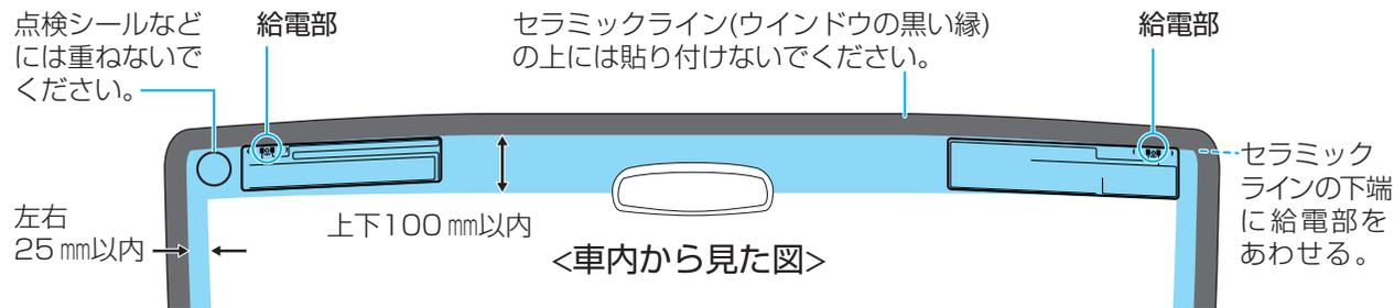
左用のアンテナの取り付けかたを例に説明しています。
