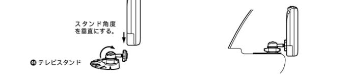
**3** ディスプレイユニットを一旦はずす。テレビスタンドのはくり紙をはがし、貼り付ける。(貼り付け場所の汚れを十分にふきとり、乾いてから貼り付けてください。貼り付けたあとは、確実に密着するよう強く押し付けてください。)
