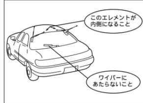
リアウィンドウ上部の左側と右側のコーナーでアンテナベースが密着する場所に貼り付けてください。左右のアンテナの貼り付け間隔の異なるようご注意ください。リアウィンドウのコーナーに貼り付けると上側エレメントがボディの外側に出る場合は、リアウィンドウのコーナーからはなして貼り付けてください。ガラスの曲面がきつクアンテナベースがガラス面にフィットしない場合は、コーナーからはなして貼り付けてください。貼り付ける前に左右のエレメントが対称になるように、ビニールテープ等で仮固定し、位置を確認してから貼り付けてください。(貼り直しできません。)
