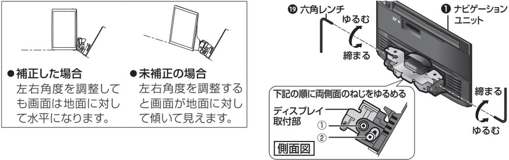
**1 ナビゲーションユニットのディスプレイ取付部のねじをゆるめる (4 か所)** ※六角レンチは長い方を持って使用してください。 ※六角レンチを紛失しないように保管してください。
