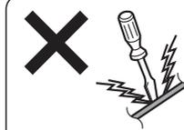
アンテナコードをドライバーなどの先のとがったもので、ピラーやルーフィングの端から無理に押し込んだりしないでください。コードが傷つき故障の原因となります。
