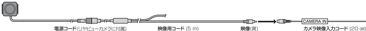
● 別売のマルチカメラシステム(CY-MCRS71KD:生産完了品)を接続する場合は、マルチカメラの信号コードを本機のリバースコードに接続してください。
