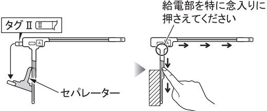
4.地上デジタルアンテナ[A]のタグⅡを持ってセパレーターをはがし、アースパターン/給電部/エレメントをしっかりとガラス面に密着させる。
