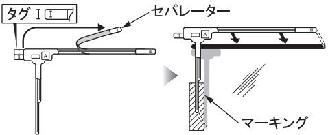
3.地上デジタルアンテナ[A]のタグⅠを持ってセパレーターをはがし、マーキングに合わせて貼り付ける。
