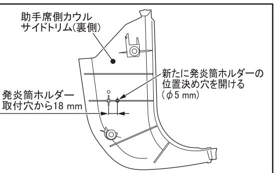
8.発炎筒を横向きに取り付けるため、助手席側カウルサイドトリムに発炎筒ホルダーの位置決めの穴を開ける。
