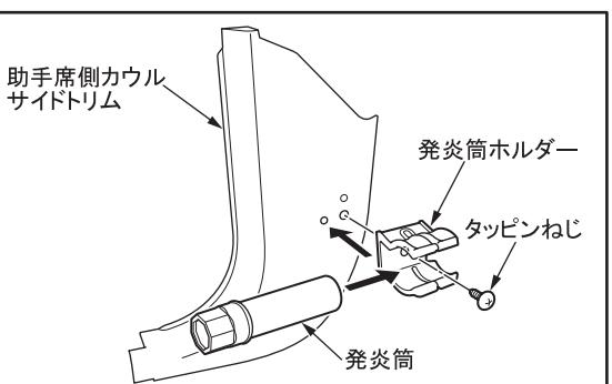
9.助手席側カウルサイドトリムに発炎筒および発炎筒ホルダーを取り付ける。
