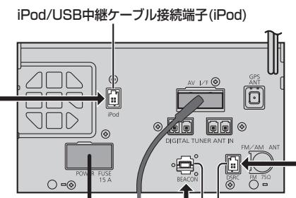
iPod/USB中継ケーブル接続端子(iPod)
