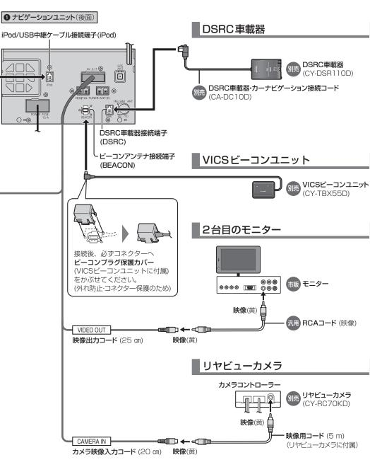
●別売のマルチカメラシステム(CY-MCRS71D \*)を接続 する場合は、マルチカメラの信号コードを本機のリバース コードに接続してください。
