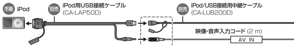
別売のiPod用USB接続ケーブル(CA-LAP50D)を使用しない場合は、下記のようにしてiPod、USBメモリー、ビデオカメラなどを接続できます。
