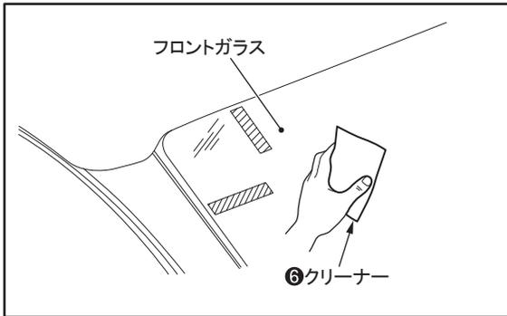
3.フロントガラス（車室内側）のアンテナ設置面の汚れ(ごみ・ほこり・油)などをクリーナーで拭き取る。
