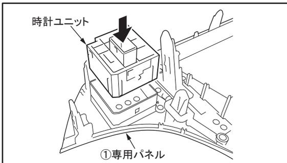
4.専用パネルに時計ユニットを取り付ける。
