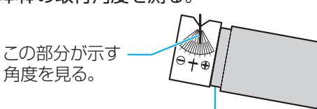
モニターの傾きを変えずに（全閉状態で）測ってください。
