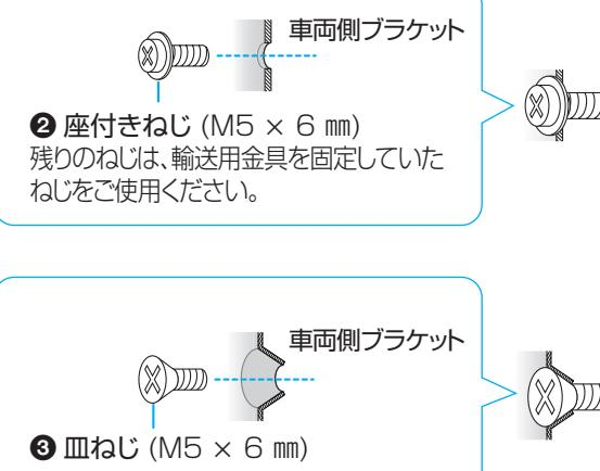
ブラケットが不安定な場合には、スペーサーで取り付けを補強し、固定してください。
