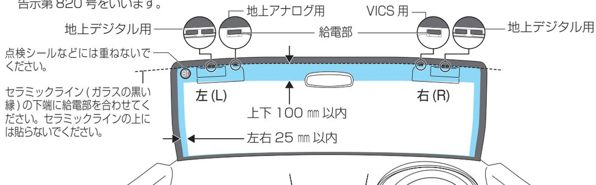
付属のクリーナー（TV・FM多重アンテナ用）で、設置面（ガラス面、ピラー）の汚れ（ごみ、油）などをきれいに拭き取ってください。
