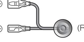
この部分は回路保護部品です。切り離したりせず、必ずこの状態のまま車速信号取り出し箇所の方向に接続してください。
