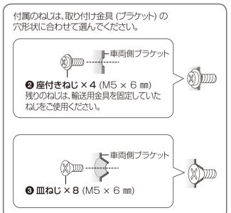
ブラケットが不安定な場合には、スペーサーで取り付けを補強し、固定してください。
