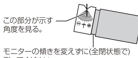
モニターの傾きを変えずに(全閉状態で)測ってください。
