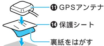
ルーフキャリアの近く、またはトランクリッドなどに取り付けると、GPS衛星からの電波を受信しにくくなります。
