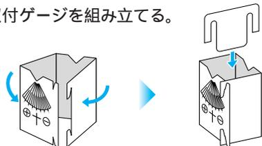
② 車体が水平になる場所で取付ゲージをナビゲーション本体の前面に図のようにあて、本体の取付角度を測る。
