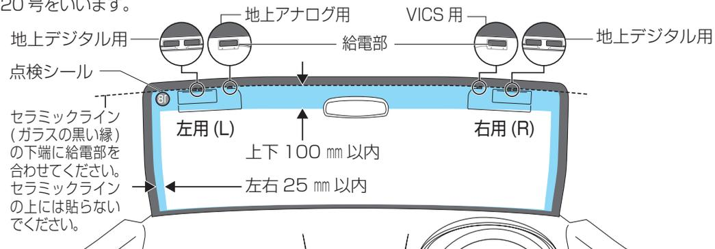
付属のクリーナー (TV・FM 多重アンテナ用) で、設置面 (ガラス面、ピラー) の汚れ (ごみ、油) などをきれいに拭き取ってください。
