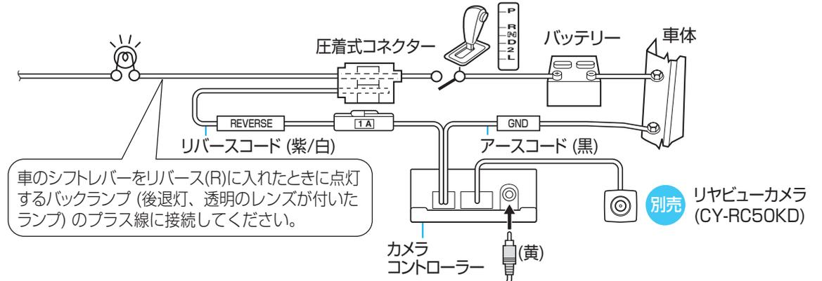
車のシフトレバーをリバース(R)に入れたときに点灯するバックランプ (後退灯、透明のレンズが付いたランプ) のプラス線に接続してください。
