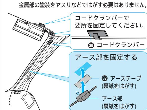
必ず、アース部をアーステープで固定してください。受信感度が低下する原因になります。配線後、ピラーをもとに戻してください。
