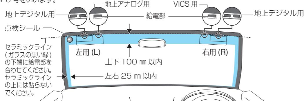
付属のクリーナー（TV・FM 多重アンテナ用）で、設置面（ガラス面、ピラー）の汚れ（ごみ、油）などをきれいに拭き取ってください。
