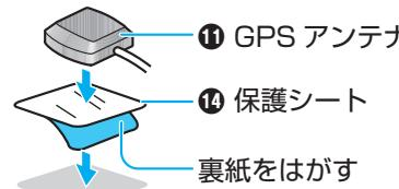
※ルーフキャリヤの近く、またはトランクリッドなどに取り付けると、GPS衛星からの電波を受信しにくくなります。
