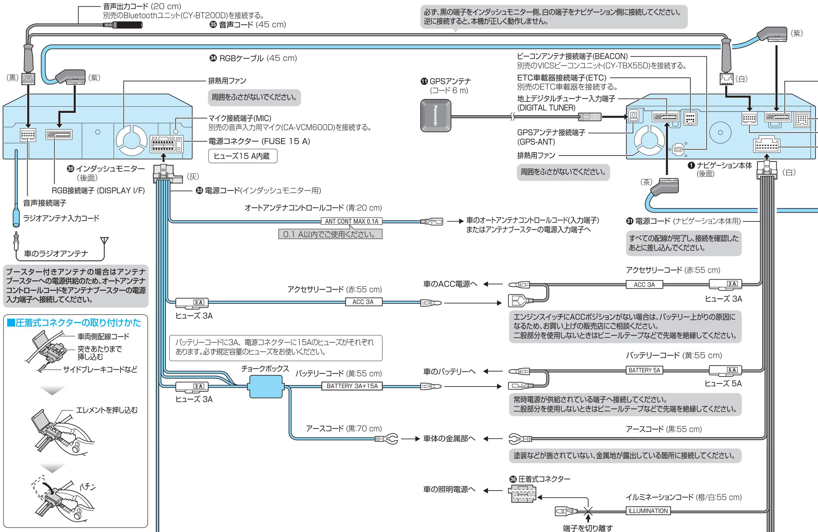
ブースター付きアンテナの場合はアンテナブースターへの電源供給のため、オートアンテナコントロールコードをアンテナブースターの電源入力端子へ接続してください。
