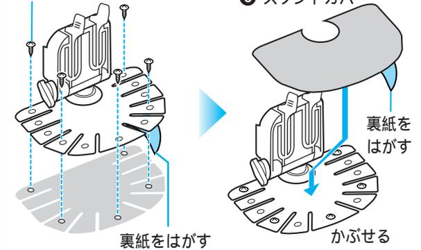
固定力を強くするため、ナビゲーション本体を取り付けずに24時間以上放置してください。
