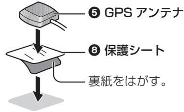
※ルーフキャリアの近く、またはトランクリッドなどに取り付けると、GPS 衛星からの電波を受信しにくくなります。
