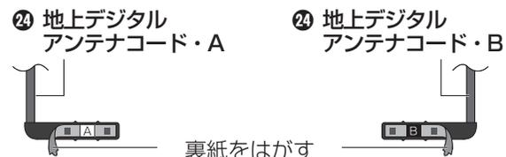
アンテナコードの端子を給電部に貼る。
