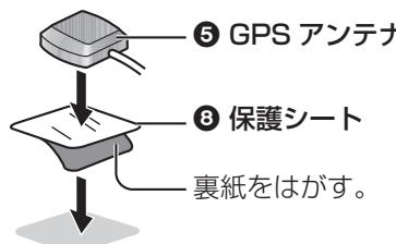
※ルーフキャリヤの近く、またはトランクリッドなどに取り付けると、GPS衛星からの電波を受信しにくくなります。
