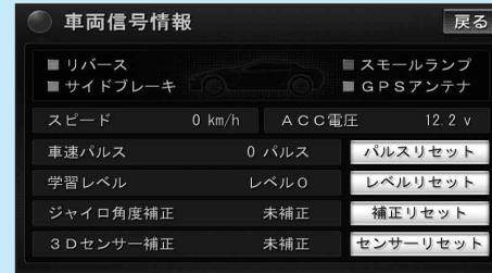
① 「リバース」「サイドブレーキ」「スモールランプ」「GPS アンテナ」「スピード」「ACC 電圧」を確認する。
