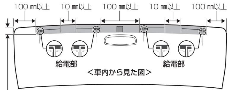
給電部をフロントガラス上端から25 mm以内に貼り付けてください。(セラミックライン上にも貼り付けられます)
