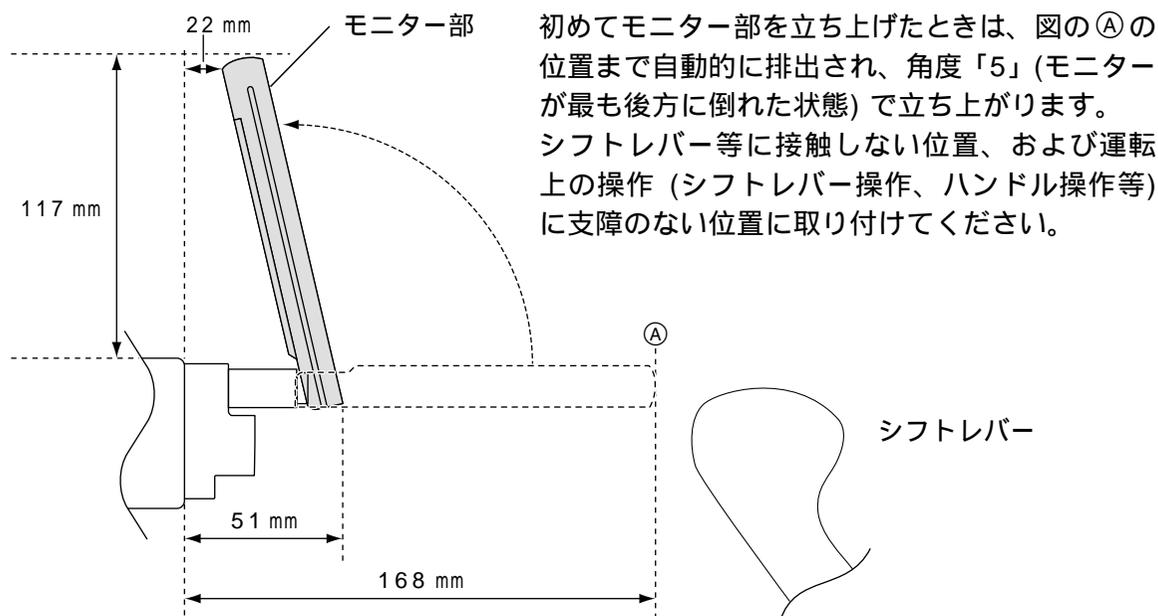
モニターが立ち上がる途中で障害物等に接触したときは、自動的にいったん前に倒れ、接触した位置よりも1段階小さい角度で立ち上がります。障害物等に接触せずに立ち上がるまで、この動作が繰り返されます。
