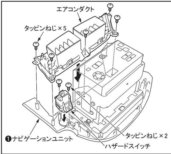
3.ナビゲーションユニットにエアコンダクトおよびハザードスイッチを取り付ける。
