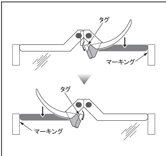
3.地上デジタルアンテナのタグを持ってセパレーターをはがし、マーキングに合わせて貼り付ける。
