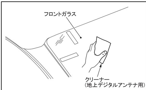
2.フロントガラス（車室内側）のアンテナ設置面の汚れ（ごみ、油）などをクリーナーで拭き取る。
