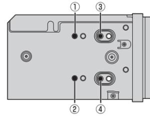
③と④のねじ穴では、スペーサー/両面テープを使用して取り付けを補強し、固定してください。
