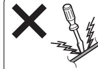
アンテナコードをドライバーなどの先のとがったもので、ピラーやルーフレイニングの端から無理に押し込んだりしないでください。コードが傷つき故障の原因となります。
