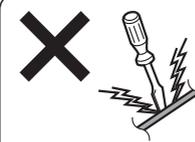
アンテナコードをドライバーなどの先のとがったもので、ピラーやルーフィングの端から無理に押し込んだりしないでください。コードが傷つき故障の原因となります。
