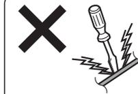
アンテナコードをドライバーなどの先のとがったもので、ピラーやルーフィングの端から無理に押し込んだりしないでください。コードが傷つき故障の原因となります。
