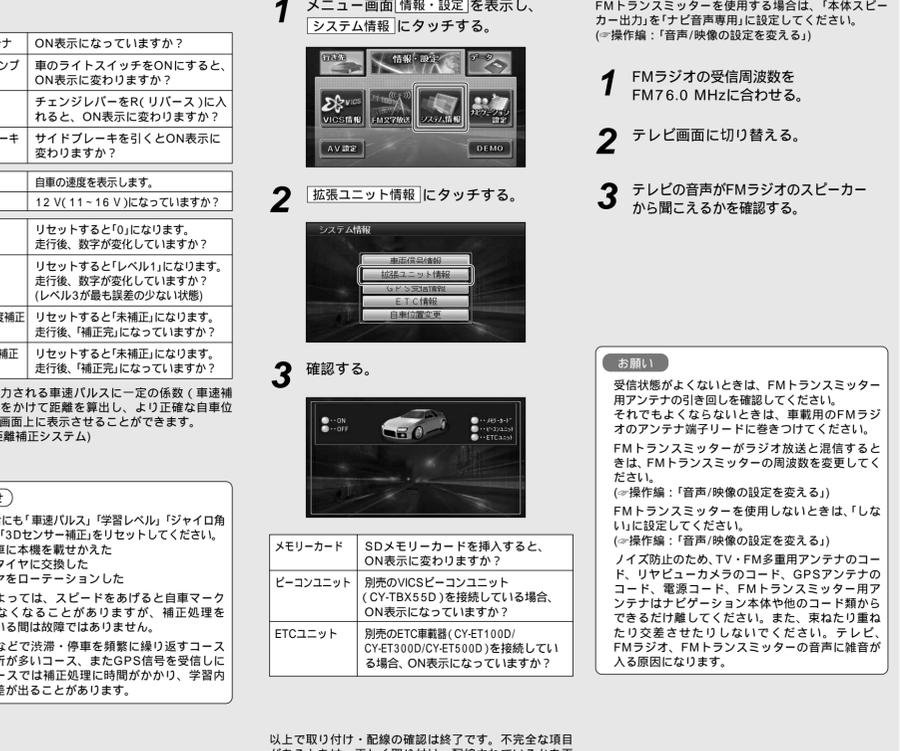
以上で取り付け・配線の確認は終了です。不完全な項目があるときは、正しく取り付け・配線されているかを再度確認してください。
