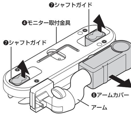
3 シャフトガイドを、ヘッドレストのシャフトの径と間隔に合わせて取り付ける
