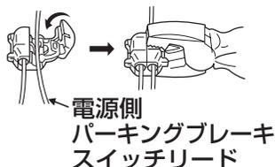
※ 接続するリードが細い場合（ $0.3 \text{ mm}^2$  以下）、接触が不十分になりますので、線の太さに合った圧着式コネクタ（市販品）をご利用ください。
