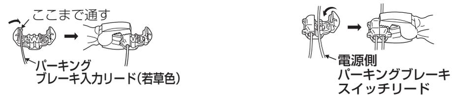
※ 接続するリードが細い場合 (0.3 mm<sup>2</sup> 以下)、接触が不十分になりますので、線の太さに合った圧着式コネクタ (市販品) をご利用ください。
