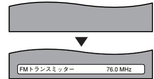
**2** **[FM]**・**[FM]**・**[チャンネル下]**・**[チャンネル上]** のいずれかを押して、周波数を設定する
