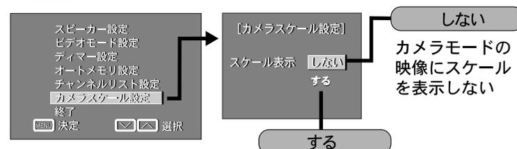
シフトレバーをリバース(R)に入れたときにカメラモードの映像にスケールを表示します
