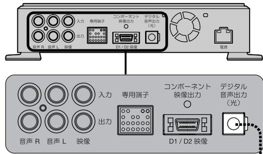
車載デジタルチューナー・ナビ接続専用ケーブル／車載デジタルチューナー・ナビ接続D2ケーブル (別売) (P.89ページ)
